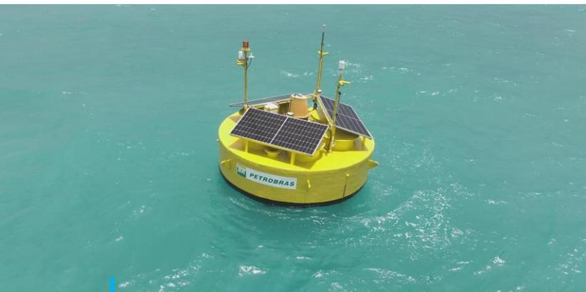
Boia Bravo identifica melhores localizações para usinas eólicas offshore
