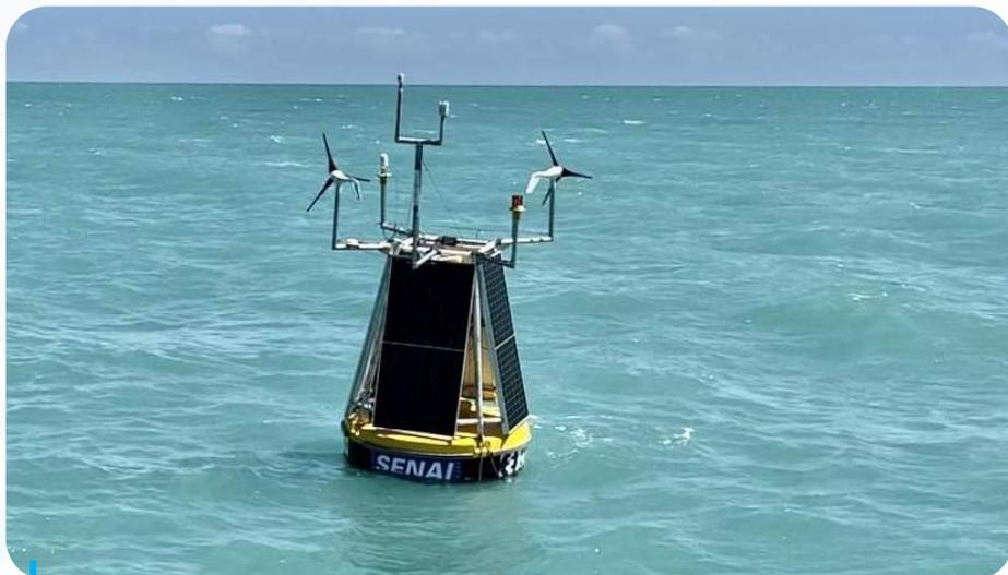
Boia Bravo auxilia a identificar local offshore com maior potencial de geração de energia eólica
