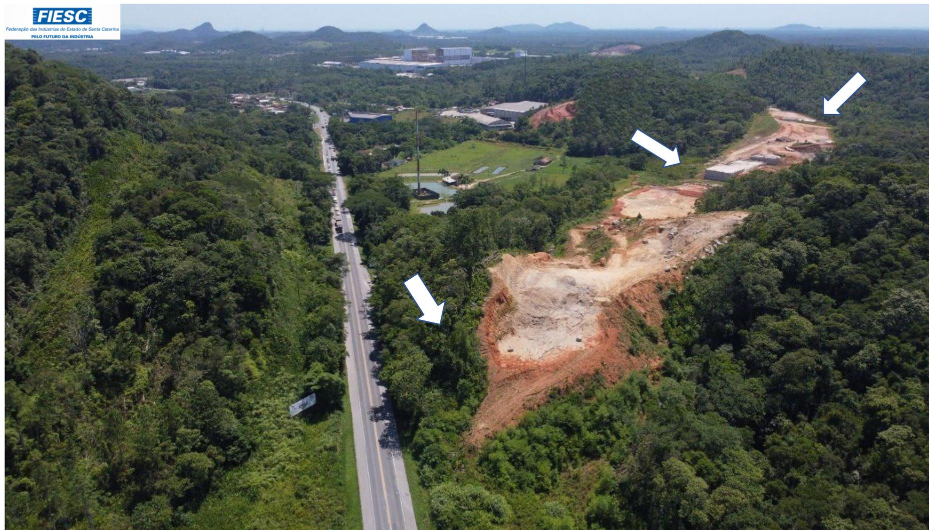
OBSERVA-SE, PELAS ILUSTRAÇÕES ACIMA, QUE O SEGMENTO DE APROXIMADAMENTE 7,0 KM – COMPREENDIDO ENTRE OS Km 03 + 840 E O 11+000 (NOVO TRAÇADO) – AINDA NECESSITA DA **EXECUÇÃO DE UM VOLUME SIGNIFICATIVO** DE TERRAPLANAGEM, BEM COMO DA EXECUÇÃO DE PAVIMENTAÇÃO E DE OBRAS DE ARTES ESPECIAIS (VIADUTOS).
