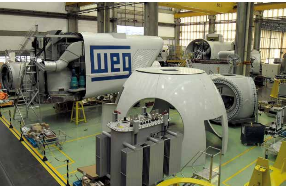
Montagem de aerogeradores na WEG: sistema completo
