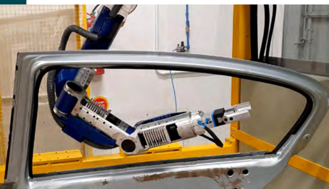
Equipamento é capaz de realizar diversas tarefas em uma fábrica, como levar ferramentas, inspecionar soldas e aplicar selantes
