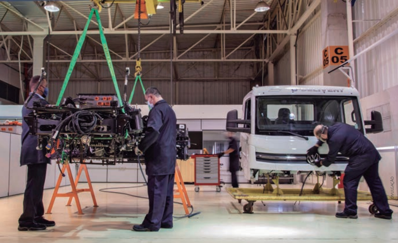
Montagem do e-Delivery e detalhe do sistema powertrain (abaixo): projeto pioneiro no Brasil
